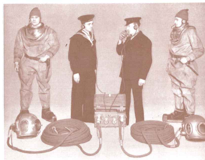
Apparecchio telefonico intercomunicante per due palombari (da "Deep diving and submarine operations" - 1935)
